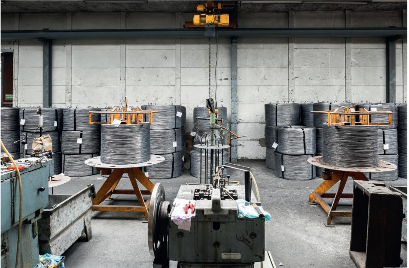
Tonnenschwere Drahtrollen, die wie gigantische Fadenspulen aussehen, dienen als Rohmaterial.
